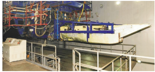
图 1 进气道/发动机台架联合试验设备安装情况
