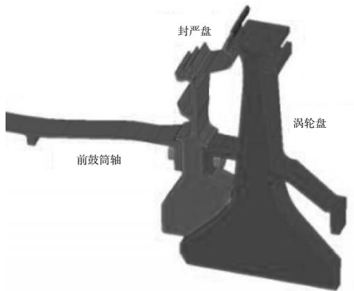
图3 轮盘连接结构
