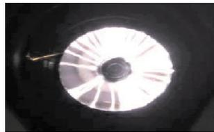
图 4 直接击穿混合气电弧等离子体点火
