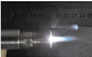
图 3 射流电弧等离子体点火
