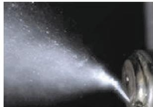
图 12 航空煤油被点火器的射流雾化(冷态)
