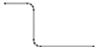
图 2 弯管 UG 模型及其标定点
