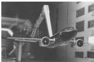
图 1 大涵道比飞行器试验
