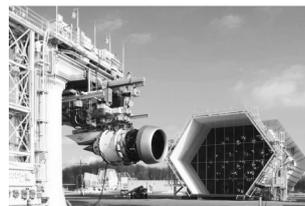
图3 CF6-50发动机侧风试验场景
