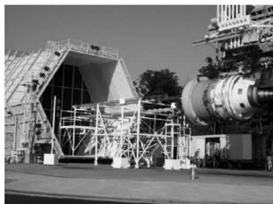
图1 GE发动机露天台吞鸟试验场景
