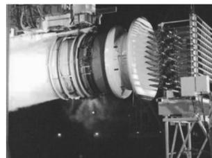
图2 CFM56发动机露天台吞水试验场景
