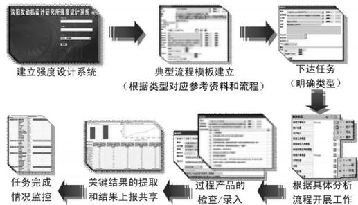
图 8 强度设计系统工作流程
