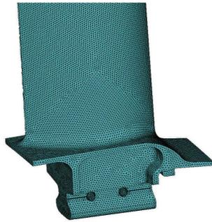
图 6 切口叶片有限元模型
