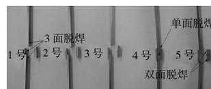
图 4 拉剪试样断裂模式
