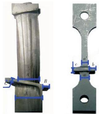
图3 叶根倒角真实件与其特征模拟件的外形
