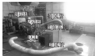
图8 试验现场布置
