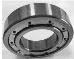
图 13 改进的拆卸试验形式 图 14 试验后轴承内圈内径表面形貌
