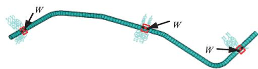
图 2 基于 ANSYS 创建的空间管路有限元模型
