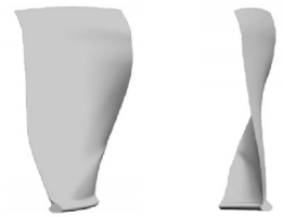
图3 空心与实心风扇转子叶片结构模型
