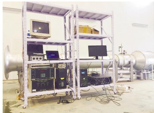
图 1 风扇试验台和测量装置
