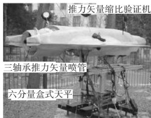
图9 三轴承推力矢量喷管测力试验台
